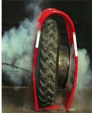
Lors d'un éclatement, des éléments de pneus ou de particules contenues dans le pneu (microbilles d'équilibrage PL, poussières) peuvent être projetées et provoquer des dommages corporels et matériels graves.
